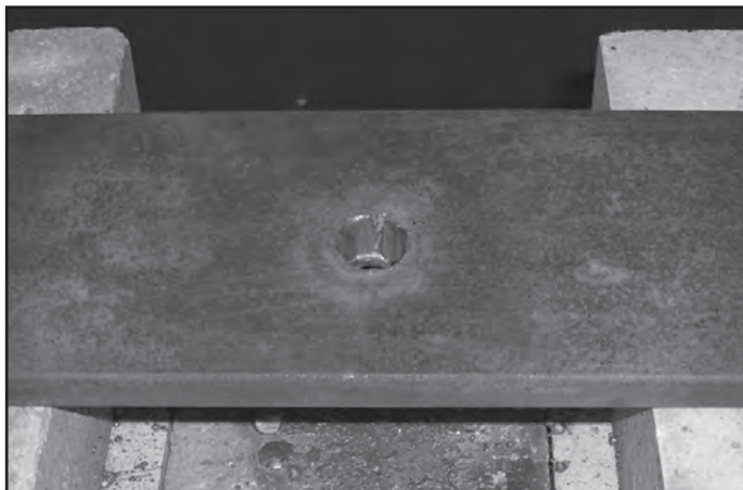
Figura 22: Corte mediante perforación
