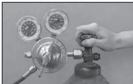
Figura 10: Abrir la válvula del cilindro
