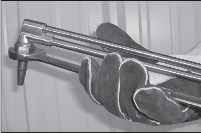
Figura 17: Cómo ajustar la tuerca de la punta
