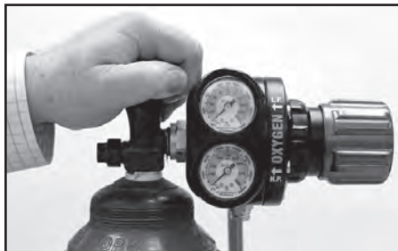
Figure 10 : Ouverture du robinet de la bouteille
