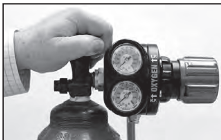
Figura 10: Abrir la válvula del cilindro
