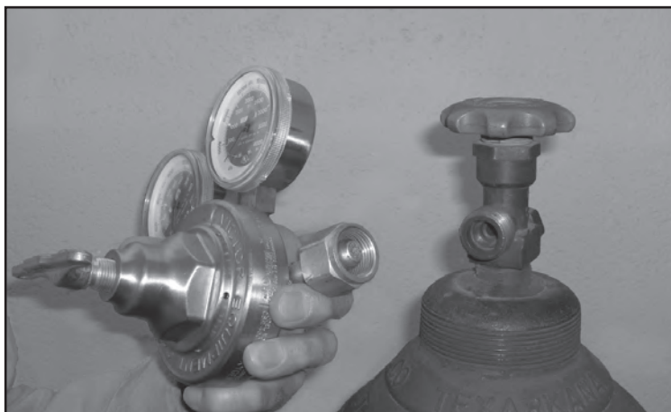
Figure 9 : Inspection de la bouteille et du robinet
