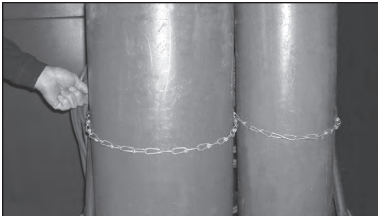
Figura 8: Cómo asegurar los cilindros en la carretilla
