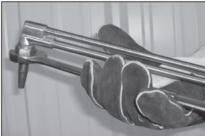
Figure 17 : Serrage de l'écrou de la buse
