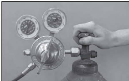
Figure 10 : Ouverture du robinet de la bouteille
