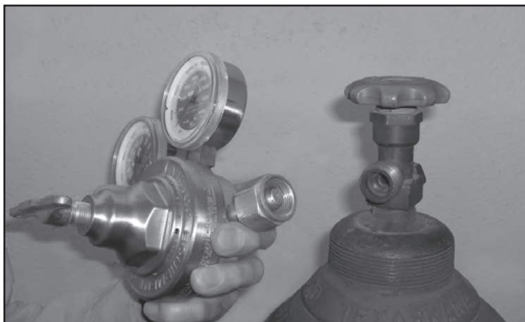
Figura 9: Cómo revisar el cilindro y la válvula del cilindro
